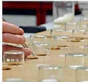
Prove di durezza e di resistenza alle macchie delle vernici. (Fonte Catas)
